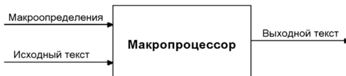
Рис. М.2. Схема работы макропроцессора
