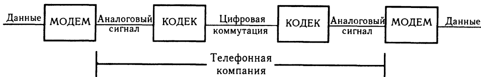
Рис. 9-17. Схема аналоговой передачи данных
