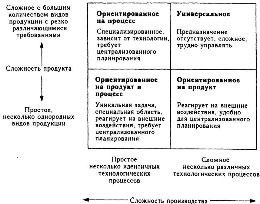
Рис. 8-2. Производство с ориентацией на продукт или процесс
