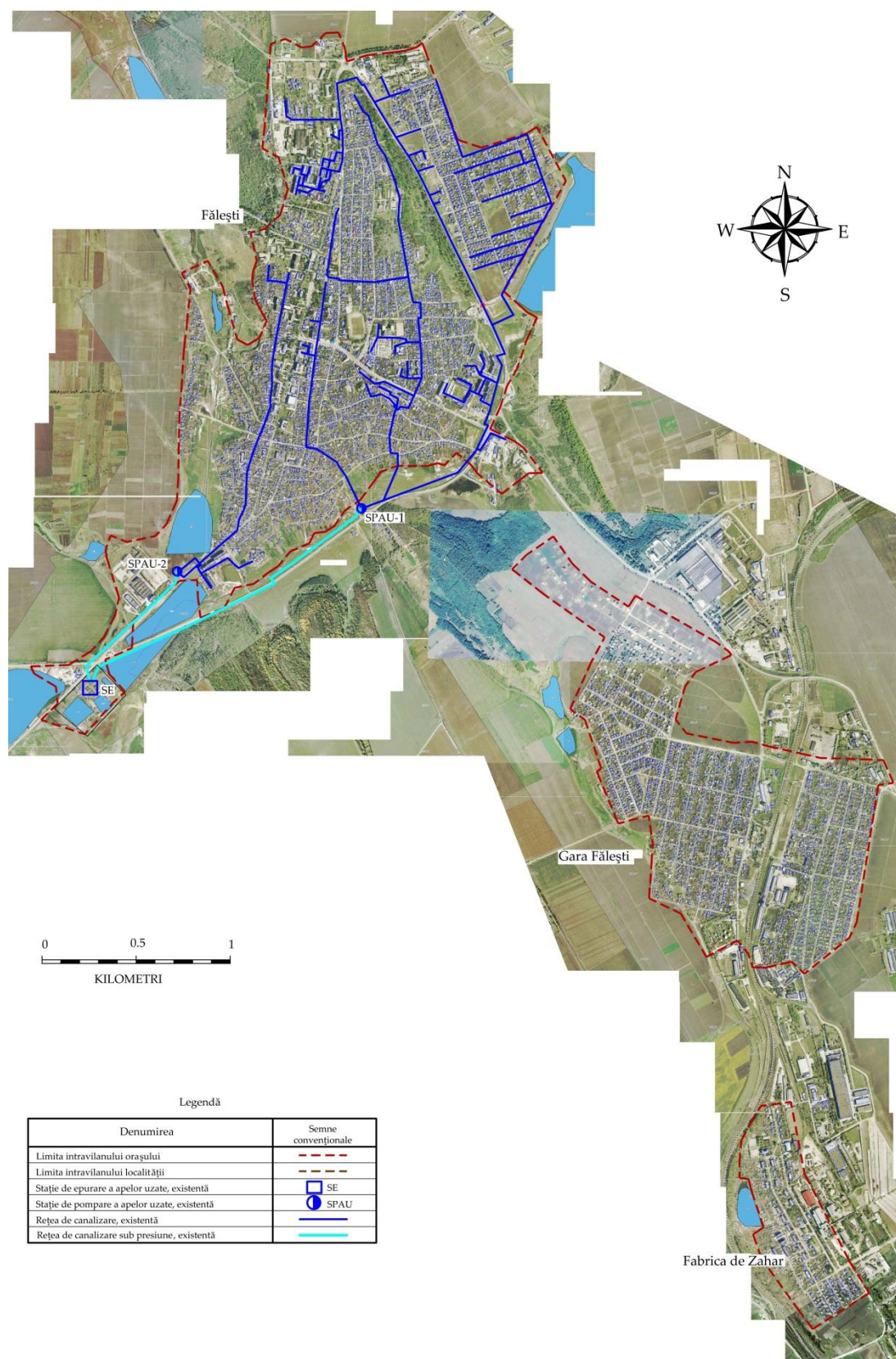
Figura 4-13: Rețelele de canalizare din orașul Făleşti
