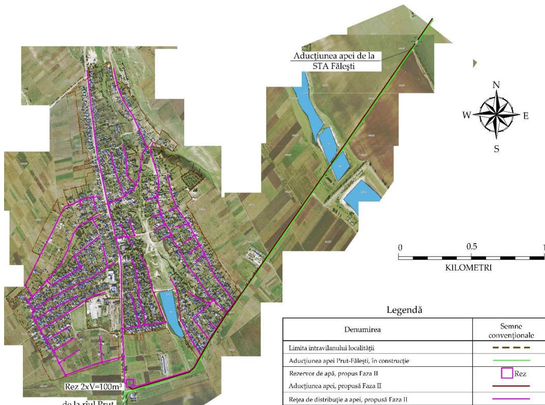
Figura 5-7: Sistemul de alimentare cu apă propus în satul Călugăr
