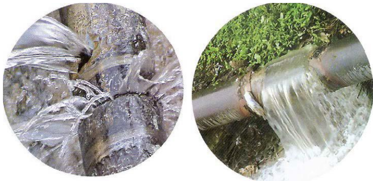
Fig. 6.3. Găurirea peretelui tubului
