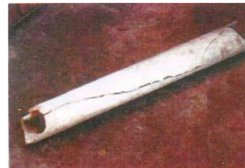
Fig. 6.4. Fisurarea longitudinală sau circumferențială
