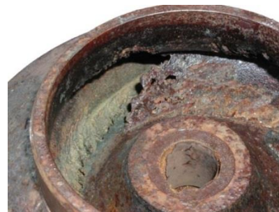
Foto. 1 Efecte ale cavitației asupra rotoarelor pompelor
