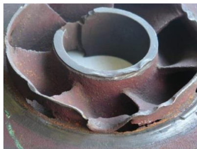
Foto. 1 Efecte ale cavitației asupra rotoarelor pompelor
