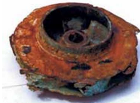
Foto 1 Efecte ale cavitației asupra rotoarelor pompelor
